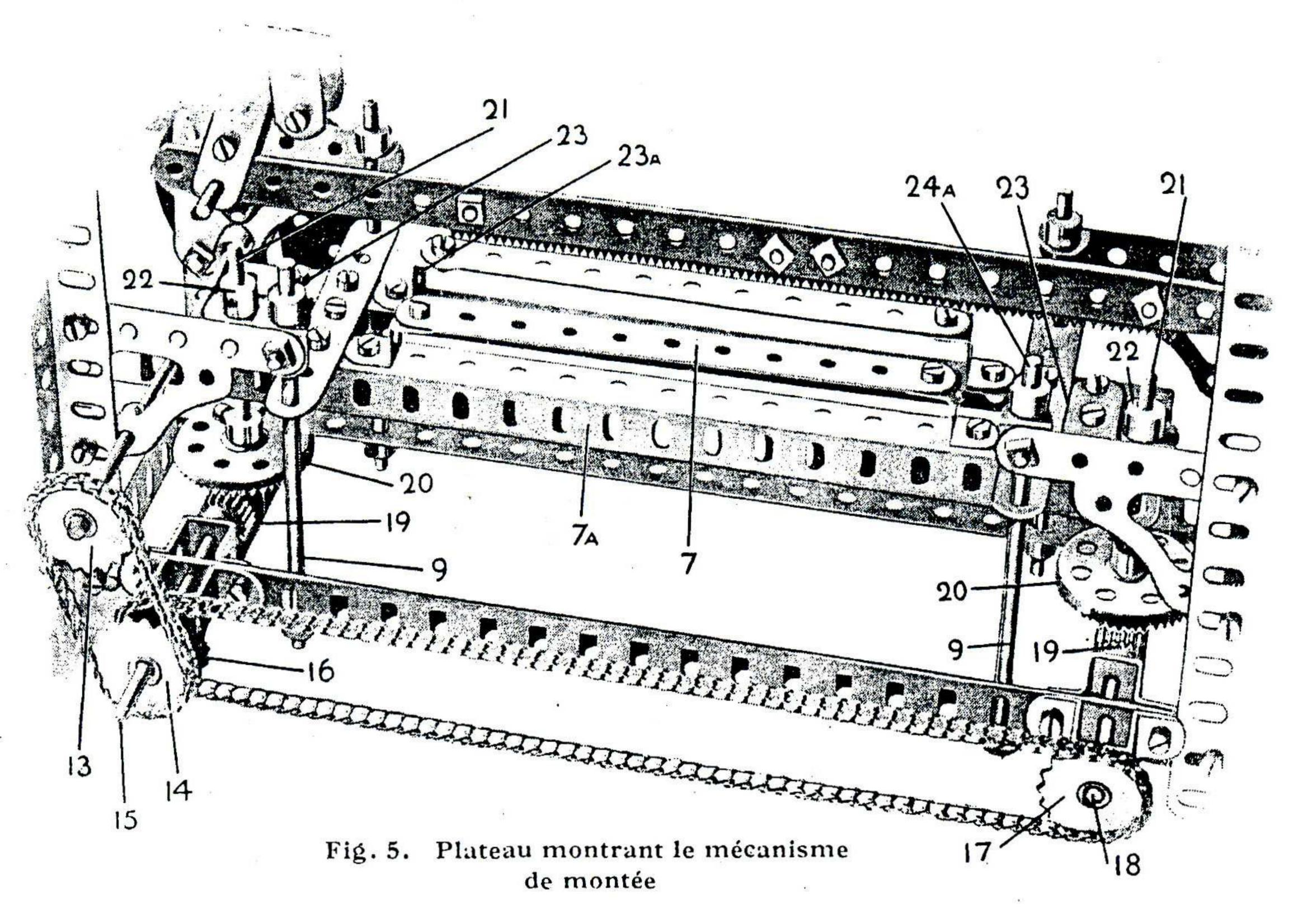
Le trolley roule sur quatre Poulies de 25 mm. dont les gorges s'appuient sur les rebords retournés des Cornières 24 (Fig. 1 et 2). Ce type de mécanisme à la main de levage est utilisé dans beaucoup d'usines et dans des ateliers pour faciliter le transport de lourdes charges par la force manuelle.
